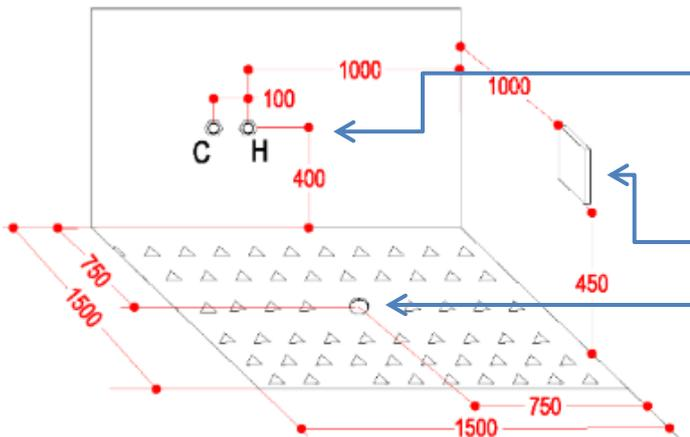
**Wasseranschlüsse mit Absperrventil und Doppelnippel ½ Zoll (Aussengewinde)**
