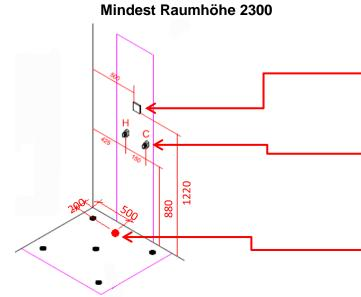
Elektroanschluss: 230V / 3.3KW / 1 Meter Kabel lose mit AP-Verteilerdose, 16Amp über FI
