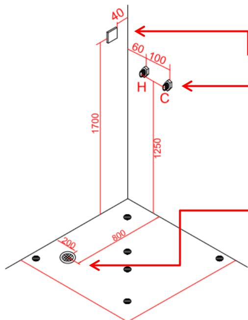
**Elektroanschluss: 230V / 3.3KW / 1 Meter Kabel lose mit AP-Verteilerdose**
