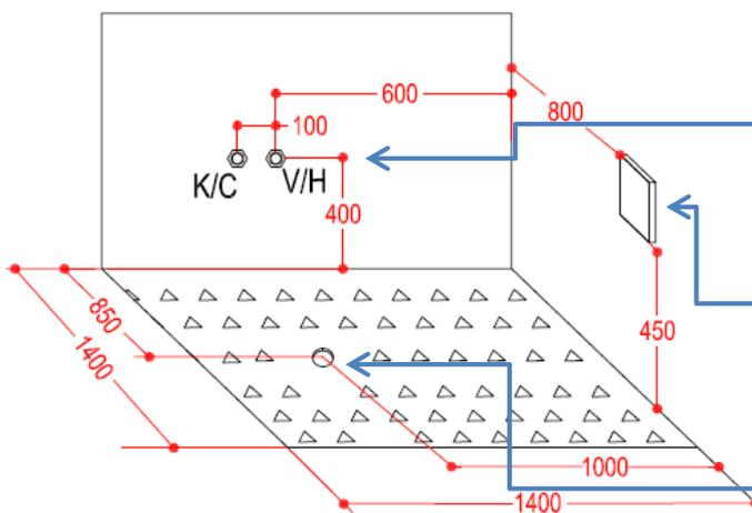
**Wasseranschlüsse mit Absperrventil und Doppelnippel 1/2 Zoll (Aussengewinde)**
