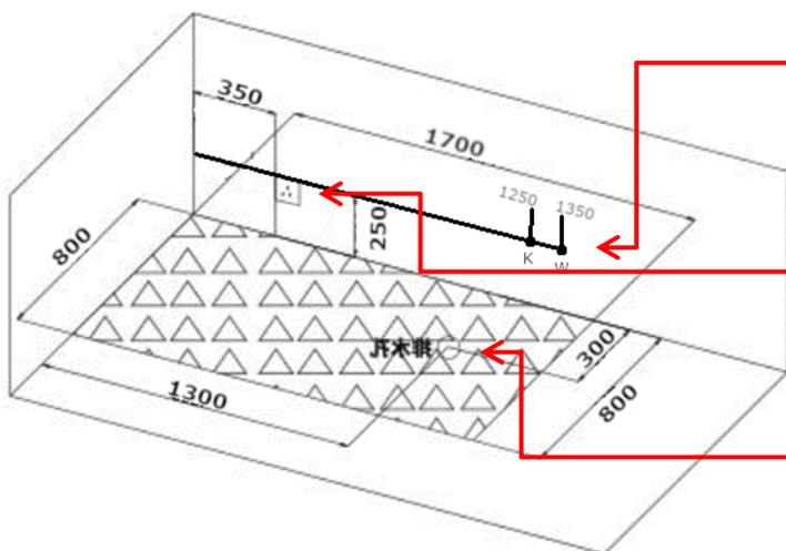
**Wasseranschlüsse mit Absperrventil und Doppelnippel 1/2 Zoll (Aussengewinde)**
